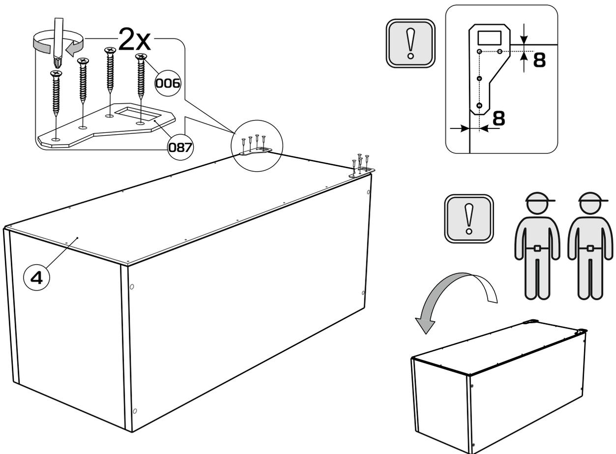
Стандартная монтажная схема по установке навесных шкафов высотой 72 и 36 см
