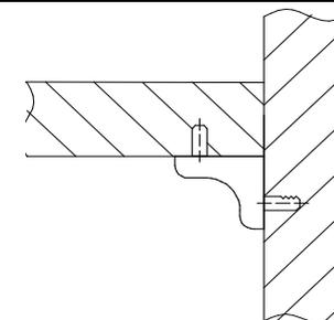
В имеющиеся отверстия на ст. вертикальных шкафа НМ 013.02-03 вставить фиксирующие полкодержатели поз.2, установить на них ст. гориз.поз.1 (см. рис.)
