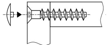
Схема крепления евровинтов (рис.2)
