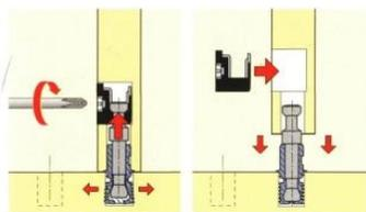
Схема установки эксцентриковой стяжки (рис.3)
