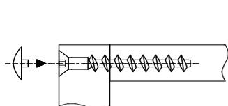
Схема установки еврвинта (рис.4)
