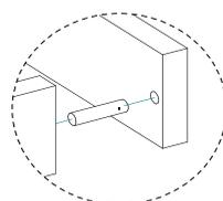
Схема установки шкантов (рис.5)
