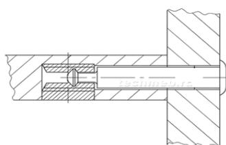
Схема установки эксцентриковой стяжки с концевым штоком (рис.6)
