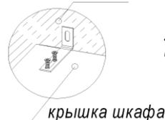
**Рекомендуется изделие закрепить к стене, для этого установить на крышке шкафа уголки поз.082 и закрепить их шурупами 4x16 (крепеж к стене в комплект фурнитуры не входит и приобретается отдельно в зависимости от типа стены)**
