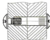
**При установке 2-х шкафов рядом, стянуть их между собой межсекционной стяжкой поз.033, для чего необходимо просверлить в стенках боковых сквозные отверстия  $\Phi 5$  мм.**
