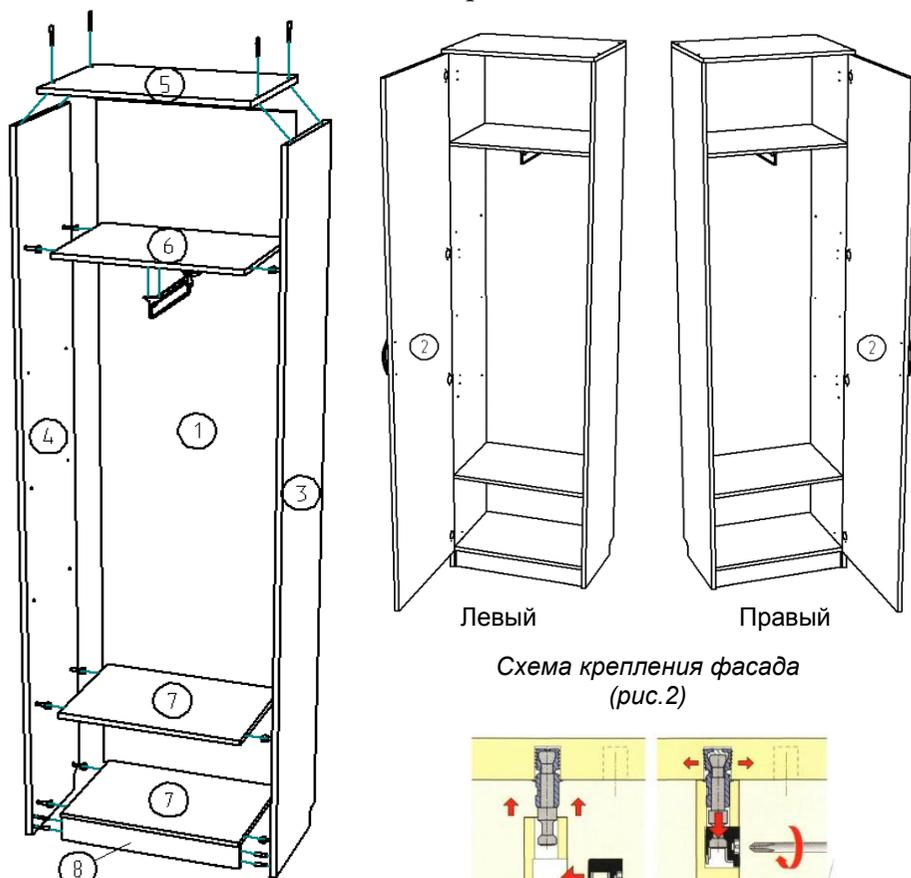
Схема крепления фасада (рис.2)
