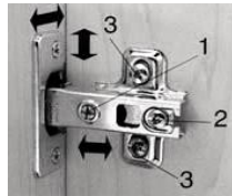
Схема регулировки четырехшарнирной петли (рис.6)
