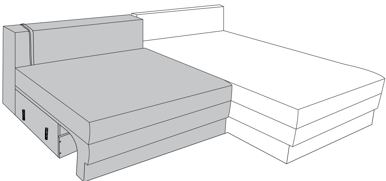
**На секциях со стороны боковин пластиковые шайбы (Н 2,5мм. и Н 7мм.) не устанавливать !!!**
