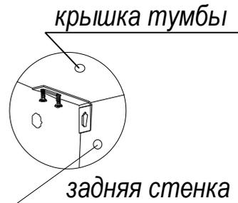
Рис.7 Рекомендуется изделие закрепить к стене, для этого установить под крышку тумбы уголки поз.082 и закрепить их шурупами 4x16 (крепеж к стене в комплект фурнитуры не входит и приобретается отдельно в
