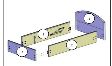
Соедините детали1,2,3. Спинку (дет.1) прикрепите к царгам боковым (дет.2) через уголки болтами М6х20 (поз.4). Царга ножная (дет.3) крепится через уголки болтами М6х20 (поз.4)
