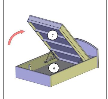
Установите матрац (дет.7) и закрепите его болтами М6х20 (поз.4). Оденьте пружины на механизмы подъема (количество пружин отличается\*).
