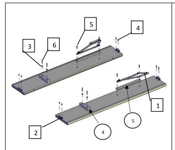
К царгам боковым (дет.2) прикрепите уголки №420 (поз.2) болтами М6х20 (поз.4). Установить механизм подъема (поз. 1) на царги боковые (дет.2), через прокладку для механизма (дет.6) и закрепить при помощи болтов М6х40 (поз.5). Закрепить упор (дет.4) на царгах боковых с помощью болтов М6х60 (поз.6).
