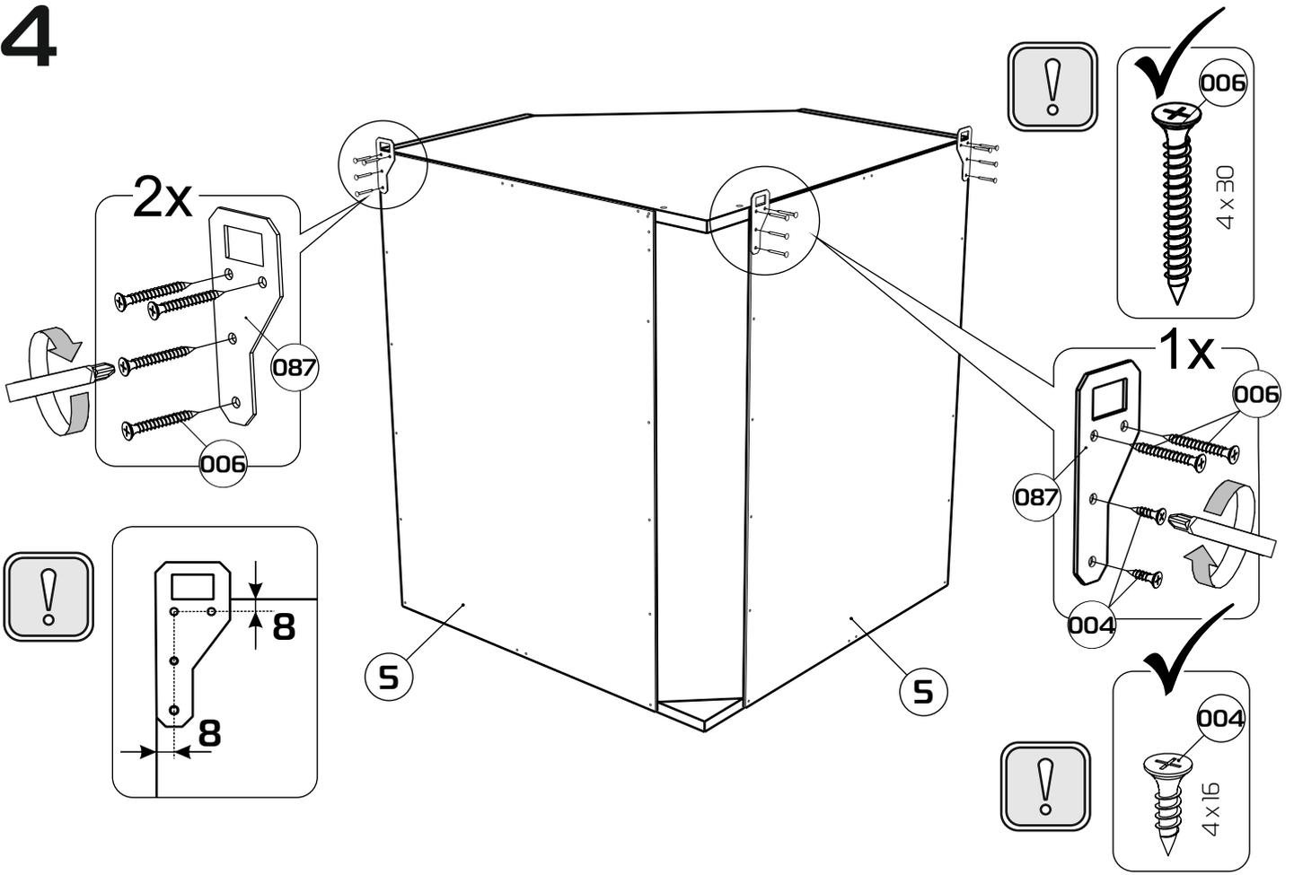
Стандартная монтажная схема по установке навесных шкафов высотой 72 и 36 см
