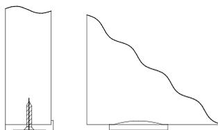
Рис.4 Схема установки евровинта 7x50
