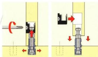
Рис.2 Схема установки двойной эксцентриковой стяжки
