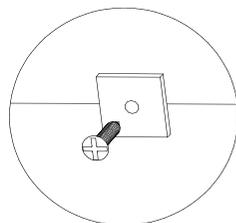
Схема установки скрепки для ДВП (рис.11)
