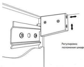
Схема регулирования подвески (рис.6)
