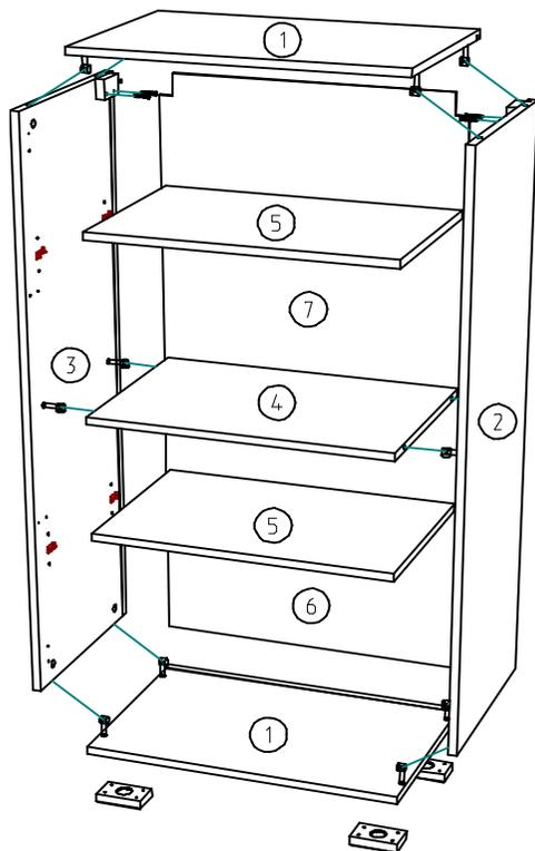
Схема сборки каркаса шкафа (рис.1)
