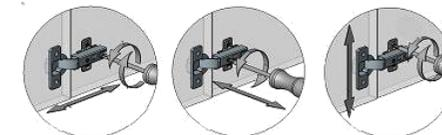
Схема регулировки накладной петли (рис.8)
