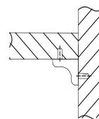
Схема утановки фиксирующих полкодержателей (рис.7)
