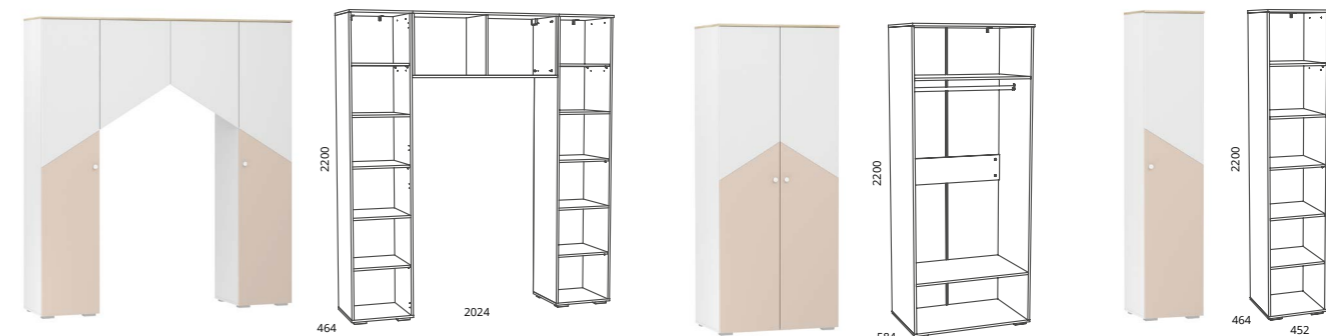
HM 041.45 Шкаф комбинированный (представляет собой 2 шкафа для одежды соединённых между собой навесной полкой с двумя дверцами)
